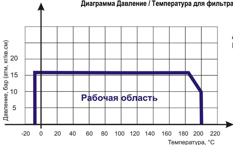
Диаграмма определяет рабочую область для фильтра сетчатого чугунного резьбового в координатах Давление (в барах приборного) / Температура (° C).
