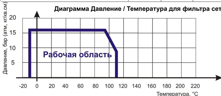
Диаграмма определяет рабочую область для фильтра сетчатого латунного резьбового в координатах Давление (в барах приборного) / Температура (° C).
